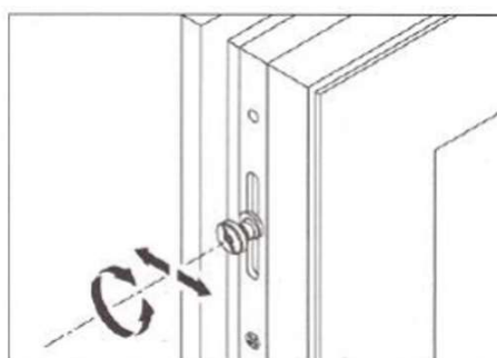
Bļvgumijas piespiešanas spēka regulēšana pa vērtnes perimetru
